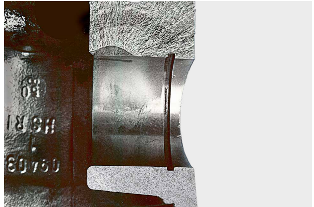
Fig. 3: Sección transversal de una bancada de bulón
